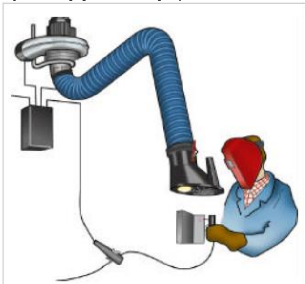
Figura 13: Equipamento de captação de fonte de emissão.
