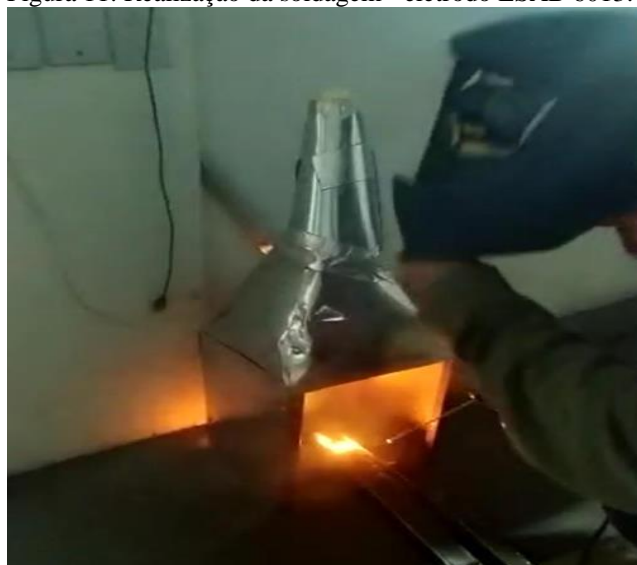
Figura 11: Realização da soldagem - eletrodo ESAB 6013.
