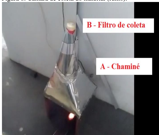
Figura 8: Câmara de coleta do material (fumo).
